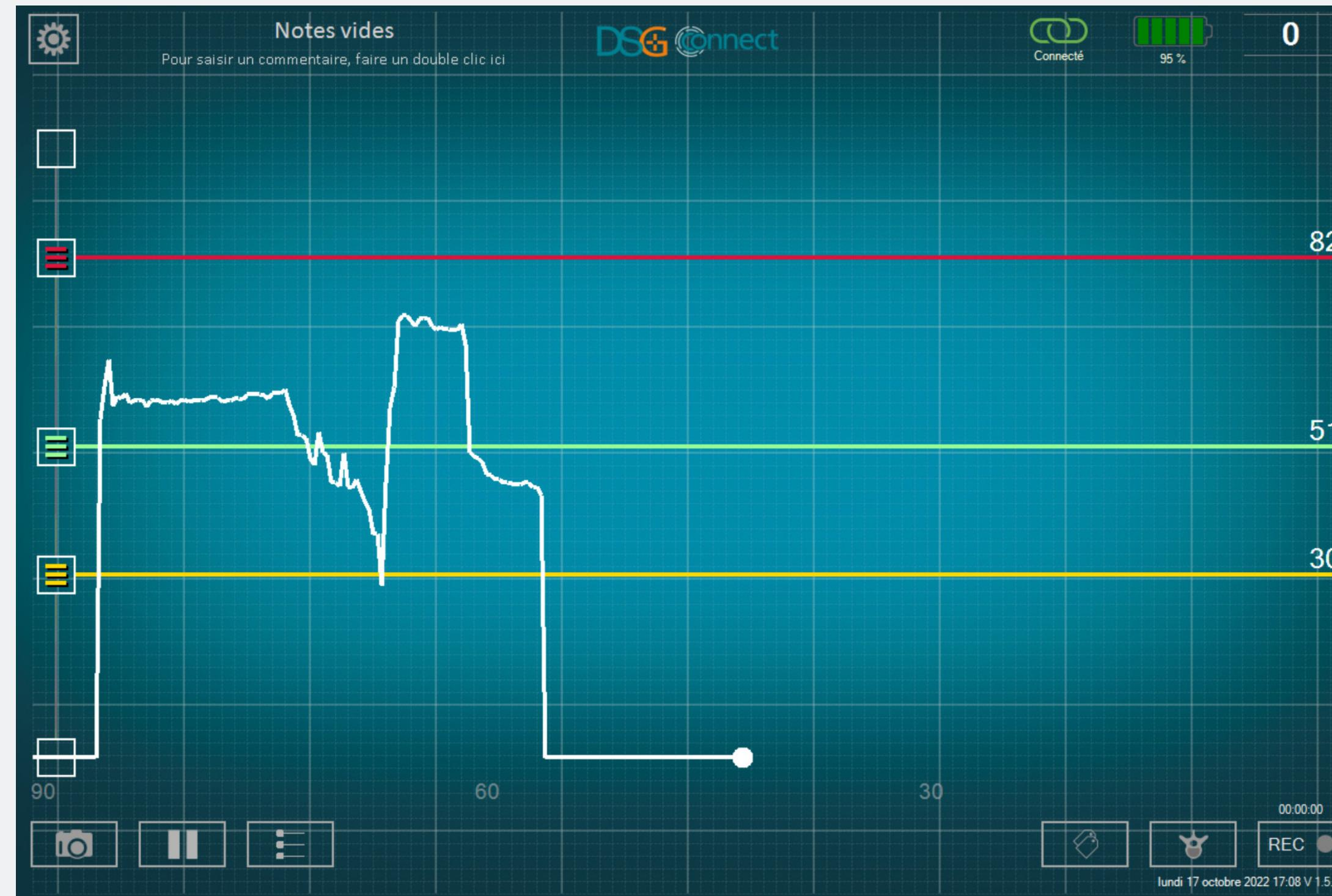
La fonction lignes de référence permet de positionner un repère sur la courbe qu'il est possible d'ajuster en fonction de votre visée.
