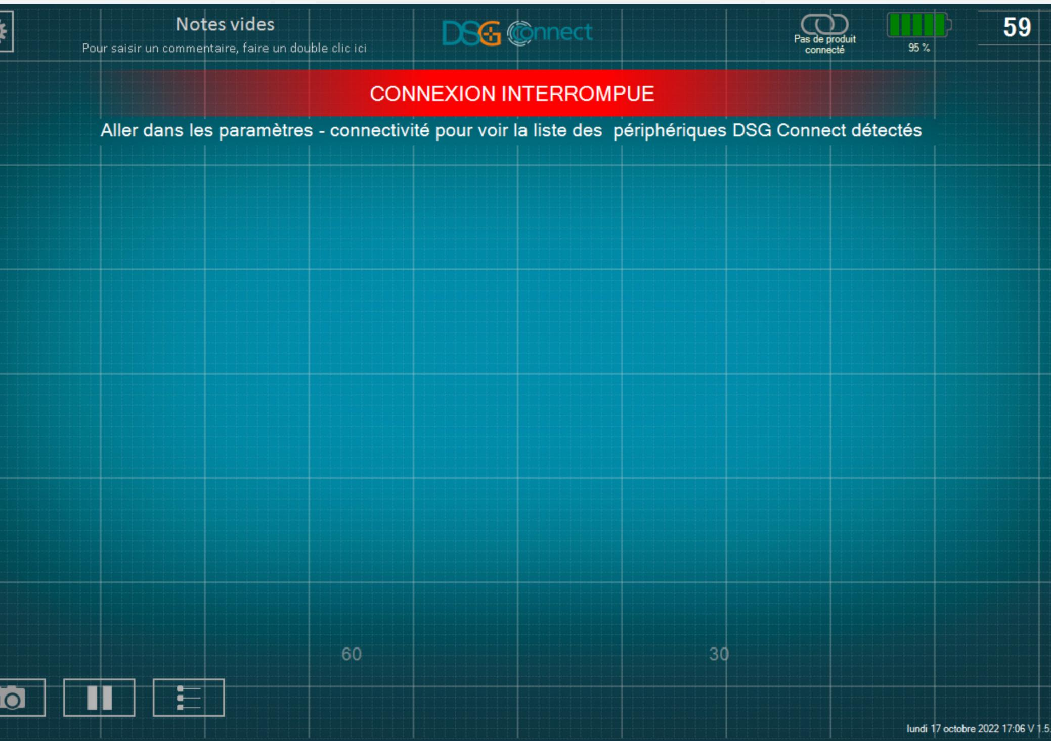
Si la communication sans fil est perdue, allez dans le menu paramètre et sélectionnez un dispositif DSG Connect actif.
