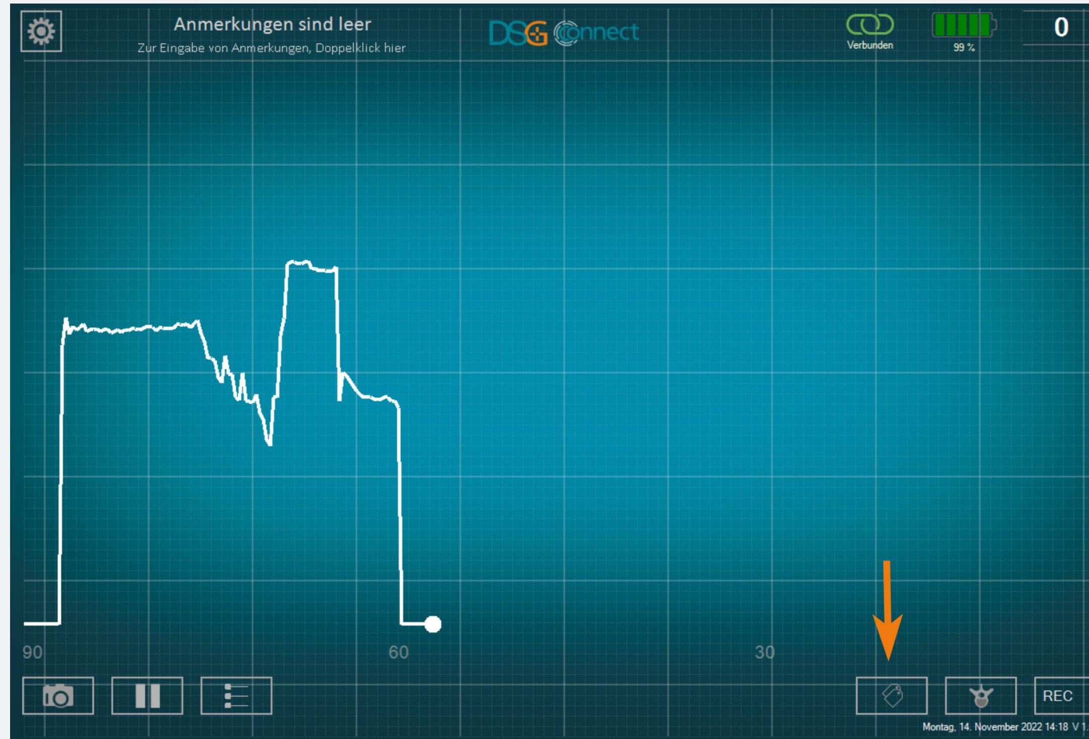
Ermöglicht die Identifizierung eines bestimmten Ereignisses während der Operation mittels Positionierung eines Tags auf dem Bildschirm.
