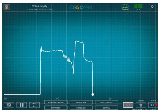
La aplicación DSG Connect vigila continuamente el nivel de batería, de la memoria y el estado de la conexión de la tableta con el dispositivo DSG Connect. Si la tableta está descargada o no tiene suficiente memoria disponible o si se pierde la conexión con el dispositivo DSG Connect, la aplicación DSG Connect emitirá notificaciones auditivas y visuales.
