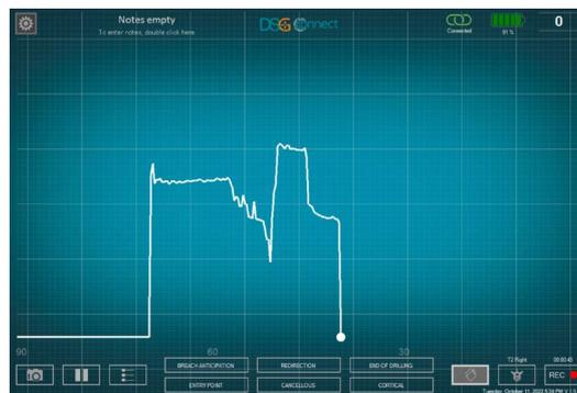
Die DSG Connect App überwacht kontinuierlich den Akku- und Speicherstand des Tablets und den Verbindungsstatus mit dem DSG Connect- Gerät. Fehlt dem Tablet Akku- oder der Speicherkapazität oder geht die Verbindung zum DSG Connect-Gerät verloren, werden in der DSG Connect App sichtbare und akustische Benachrichtigungen angezeigt.
